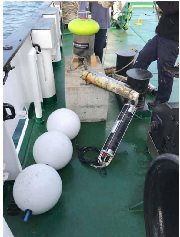
Figure 2. Chaîne de mesure acoustique sous-marine avant le déploiement du RV Belgica. Un C-POD (détecteur acoustique de marsouins) est ajouté à l'amarrage (à côté du largage acoustique). Une bouée pop-up (à l'extrémité) est utilisée pour récupérer le bloc de béton. Photographie de A. Norro.
