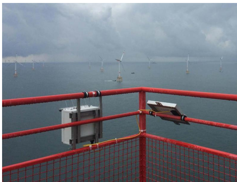
Figure 2. Batcorder installé sur la plate-forme de treuillage de l'hélicoptère à l'arrière de la nacelle de la turbine I1.
